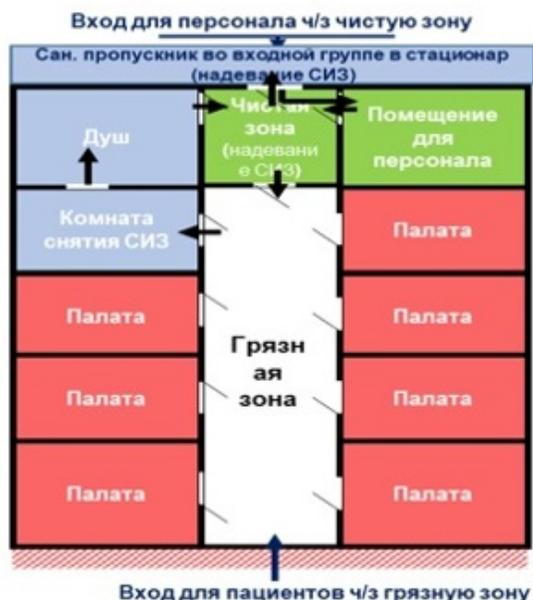
Схема модульного инфекционного стационара
